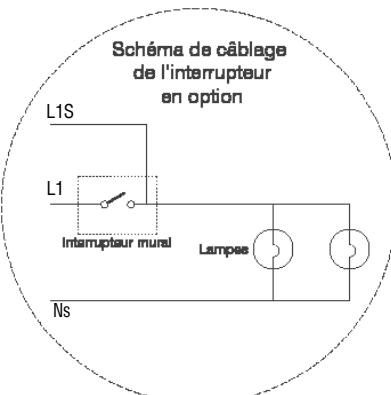
Interrupteur en option (WS) : Procure un relais interne qui permet d'utiliser deux circuits d'alimentation de secours pour les lampes, peu importe la position de l'interrupteur mural (MARCHE ou ARRÊT).
